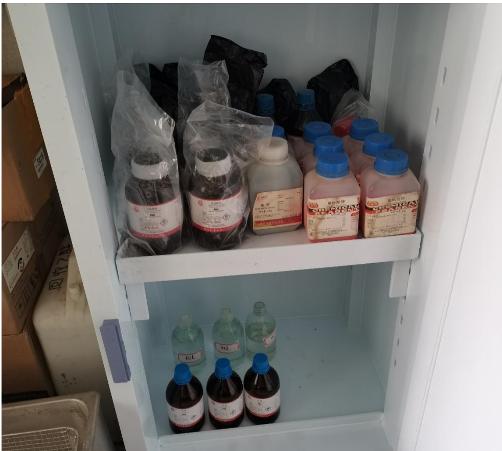
专柜存放过多废旧危化品试剂
